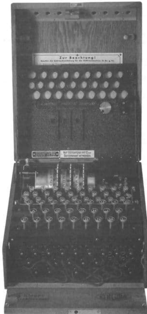
Fig. 40 Machine Enigma de l'armée avec son couvercle intérieur relevé, découvrant les trois rotors.
