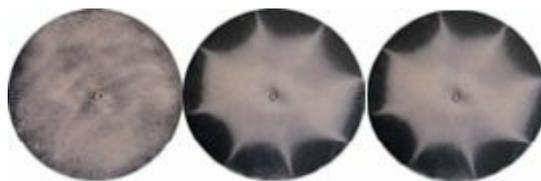
Du sable est déposé sur une plaque métallique (1<sup>ère</sup> image), puis à l'aide d'un archet de violon frotté sur le bord de la plaque, cette dernière se met à vibrer et le sable s'organise pour former différentes formes en fonction du son (2<sup>ème</sup> et 3<sup>ème</sup> image).
