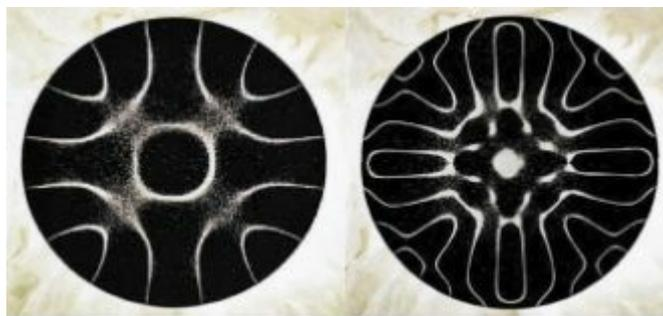
Le sable se concentre sur les lignes où l'amplitude des vibrations de la plaque est minimum. Le motif représente donc l'activité énergétique inversée, car la matière se pose là où l'énergie trace des lignes de repos.
